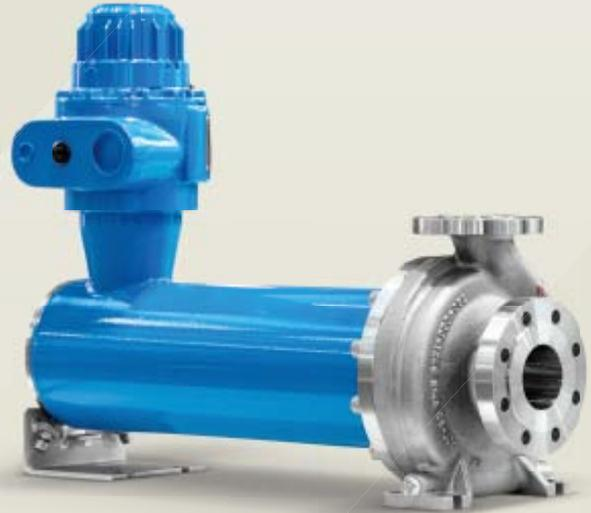
Die NIKKISO Spaltrohrmotorpumpe wird speziell in der chemischen Industrie für Transfer- und Zirkulationsaufgaben eingesetzt, insbesondere für kritische Fluide. Aus der kompakten Bauweise mit Pumpe und Motor als ein Bauteil, kombiniert mit zwei Sicherheitshüllen, resultiert eine leckagefreie und sichere Maschine. Auch höchste Anforderungen nach der API 685-Norm können erfüllt werden.
