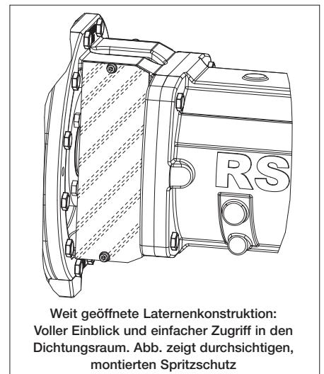
Die Abb. zeigt eine Pumpe mit doppelwirkender Gleitringdichtung und Dauerfettsschmierung.
